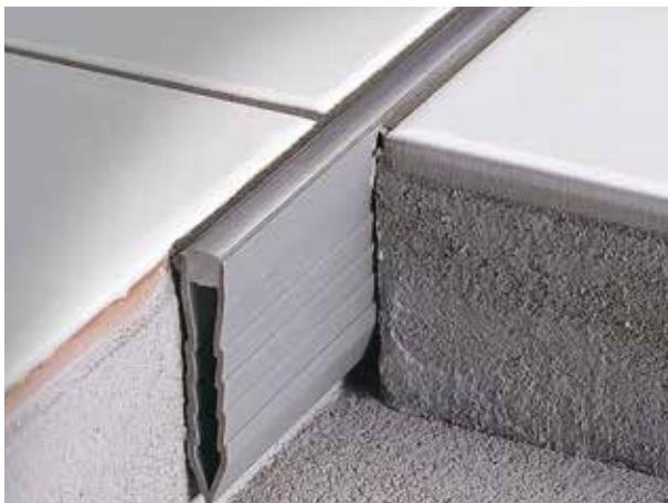
Joint de fractionnement pour pose sur mortier en matériau synthétique. Conçus pour fractionner des surfaces carrelées de grandes dimensions en zones plus petites. Ils offrent une protection limitée au chant du revêtement. Ces joints peuvent absorber de petits mouvements dus à la dilatation des matériaux de support mais seulement en compression ou en glissement. Domaines d'application typiques: centres commerciaux, aires de récréation comme hôtels, centres sportifs et écoles
